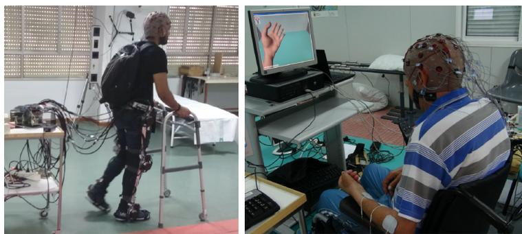
(a) Exoesqueleto controlado por BMI. (b) Compensación funcional mediante FES, controlada por BMI.
