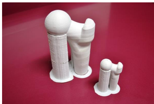
Figura 7. 1 Impresión del fémur humano en 3D
