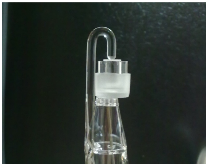
Figura 4.16: Portamuestras para medir líquidos en TMA
