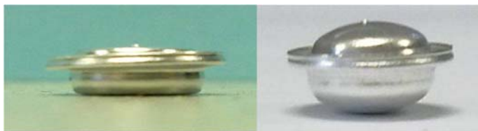
Figura 4.2: Celdas de aluminio. Sin deformar (izda.) y deformada tras calentamiento a 570°C por estar sellada (dcha).
