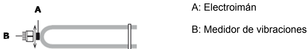
Figura 4.9 Esquema simplificado de la celda de medida del densímetro [Operating instructions DE40/45 Mettler Toledo].
