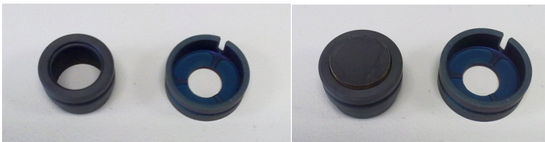
Figura 4.22: Portamuestras de sólido de 12,7mm vacío y con muestra de patrón en su interior
