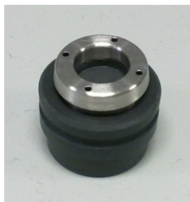
Figura 4.26: portamuestras de Pt/Rh para líquidos sobre el portamuestras de sólido
