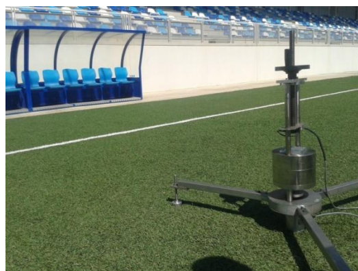
Figura 4. Atleta mecánico para la valoración de absorción de impacto y restitución energética.
