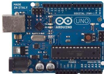
Figura 3.2. Placa Arduino Uno
