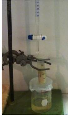
Figura 5: Dispositivo experimental de percolación de disoluciones metálicas a través de una micro-columna de fosfatos metálicos
