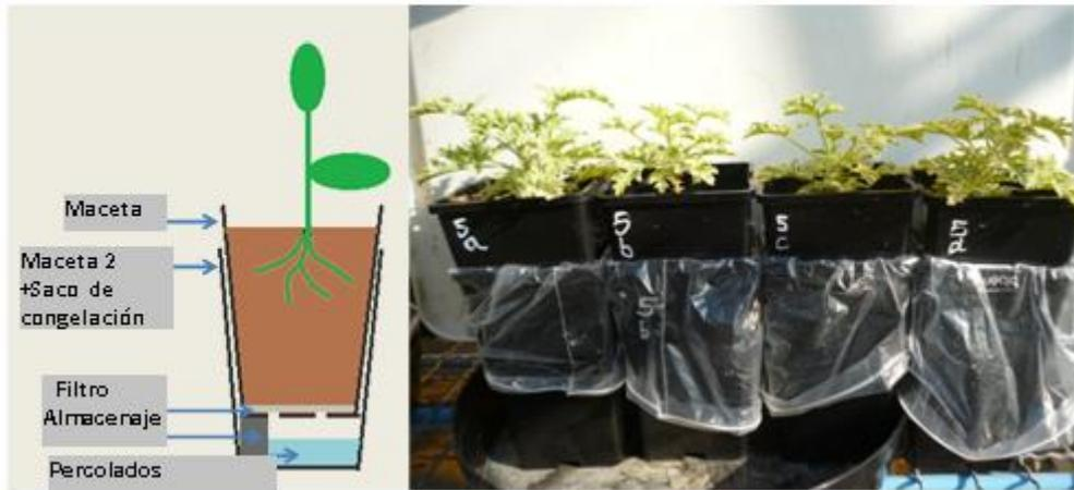
Figura 7: Sistema de colecta de los percolados
