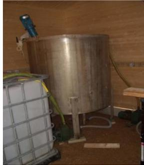
**Precipitación : depósito de mezcla y de decantación**
