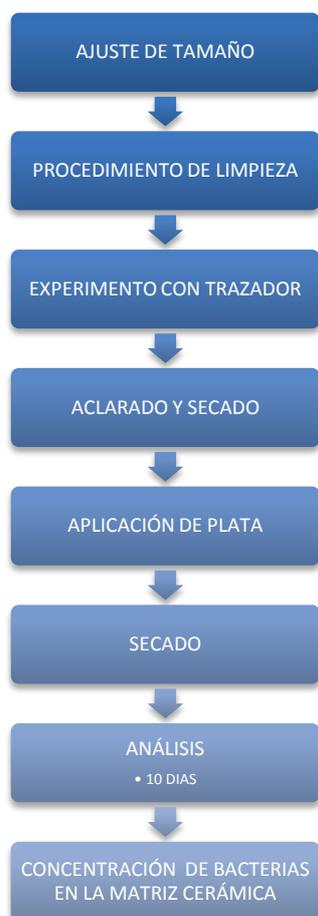
**Figura 3: Secuencia de procesado y tests**
