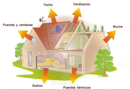
Figura 3. Envolvente del edificio
