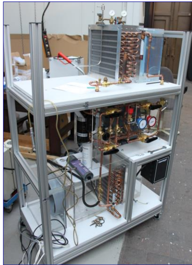
Figura 29: Aspecto real del ciclo de refrigeración (inacabado)
