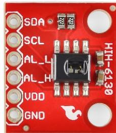
**Figura 36.** Sensor de humedad relativa y temperatura.
