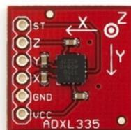
Figura 33. Acelerómetro analógico basado en ADXL335.
