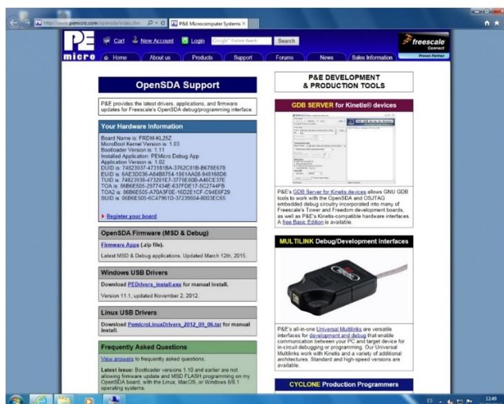
Figura 15. Comprobación versión Bootloader en plataforma Freescale Freedom FRDM-KL25Z.
