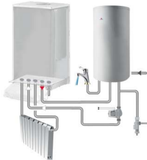
Figura 2-10: Esquema básico de la instalación propuesta por el fabricante (Fuente: Catálogo Saunier Duval)
