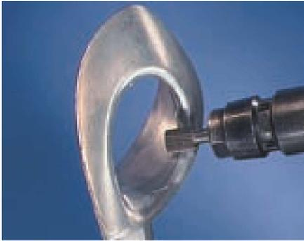
Fresa cilíndrica con dentado frontal.
