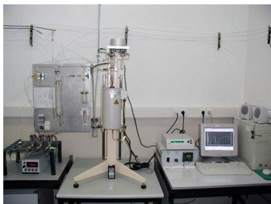
**Figura 2.2.** Termobalanza CI TG system con sistema de preparación de gases y alimentación de vapor de agua para estudios cinéticos a presión atmosférica.
