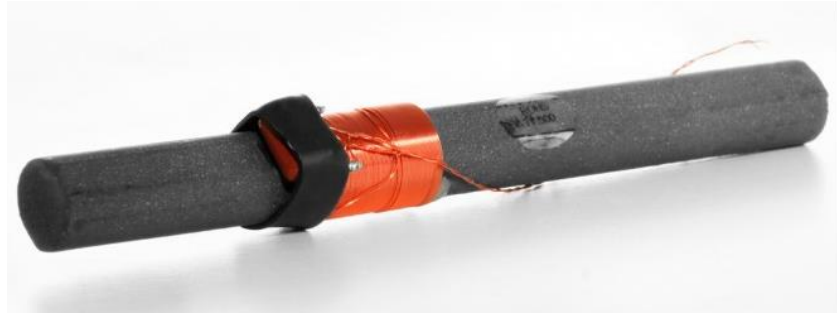
Figura 13. Antena de ferrita usada en el prototipo
