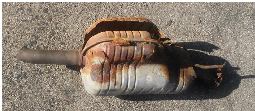
Figura 2. Tubo de escape corroído por la sal, de un coche de la zona. Elaboración propia.
