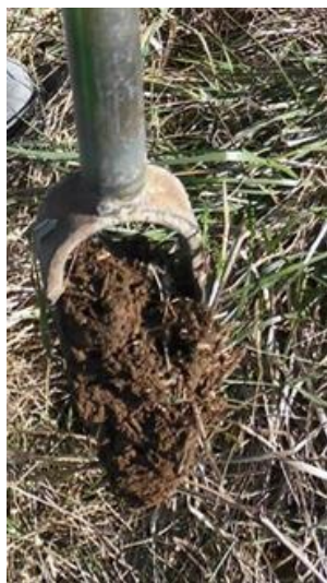
Figura 11. Barrena extrayendo suelo de aproximadamente 20 cm. Elaboración propia.
