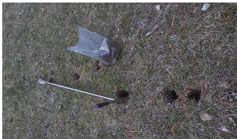
Figura 10. Agujeros de distintas tomas de muestra en Canfranc pueblo (para preparación de muestra compuesta). Elaboración propia.
