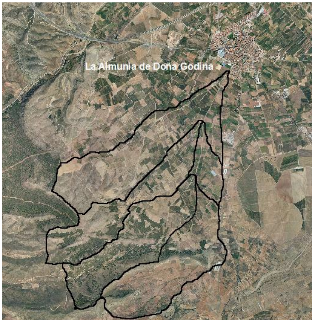
Ilustración 2: Cuenca vertiente al núcleo urbano de La Almunia de Doña Godina, constituida por los barrancos de Fontellas y Cantalobos.
