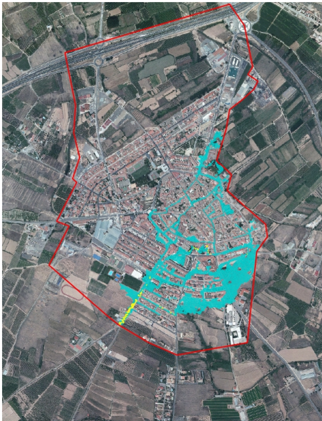
Ilustración 185: Mapa de peligrosidad del producto Calado-Velocidad para la hipótesis Actual; T=100 años
