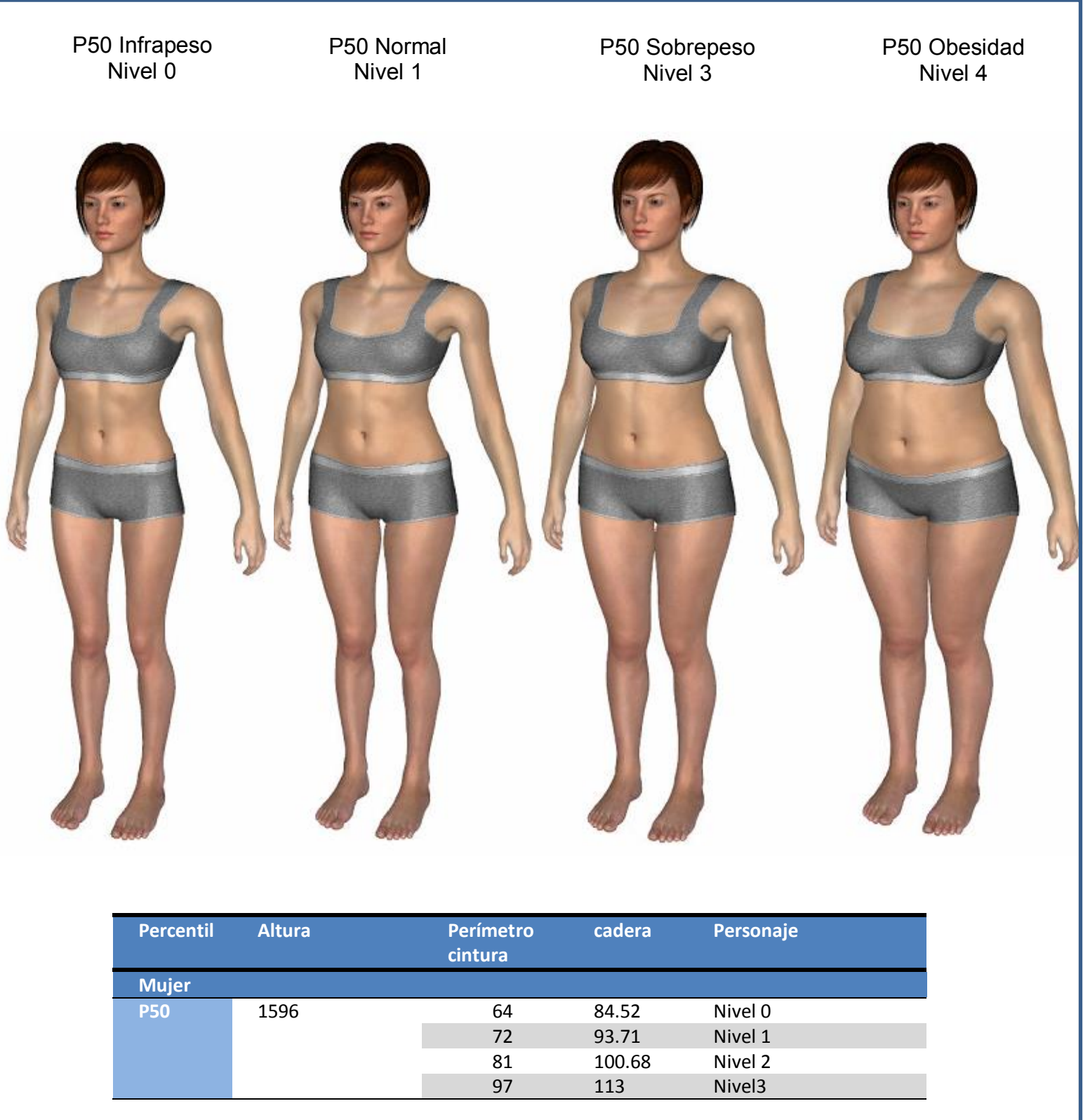
Figura 28 Modelos morfológicos de mujer de P50 y medidas claves utilizadas en el diseño
