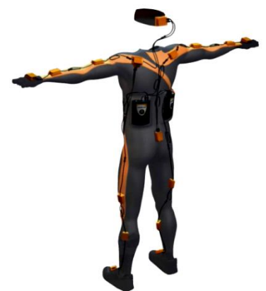
Figura 1 Traje de la compañía Xsens compuesto de 17 sensores inerciales y magnéticos que se comunican con el ordenador a través de conexión Wireless
