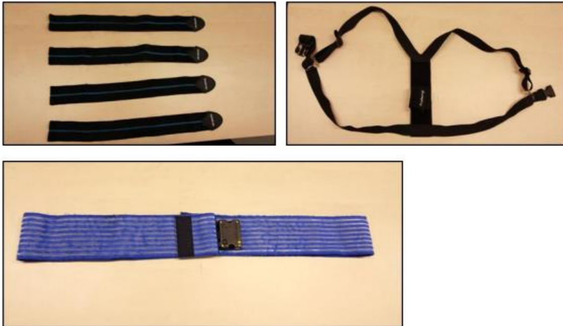
Figura 35 Fijaciones de los sensores
