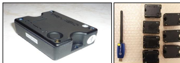
Figura 34 Sensores Colibrí y "Dongle" USB de comunicación.
