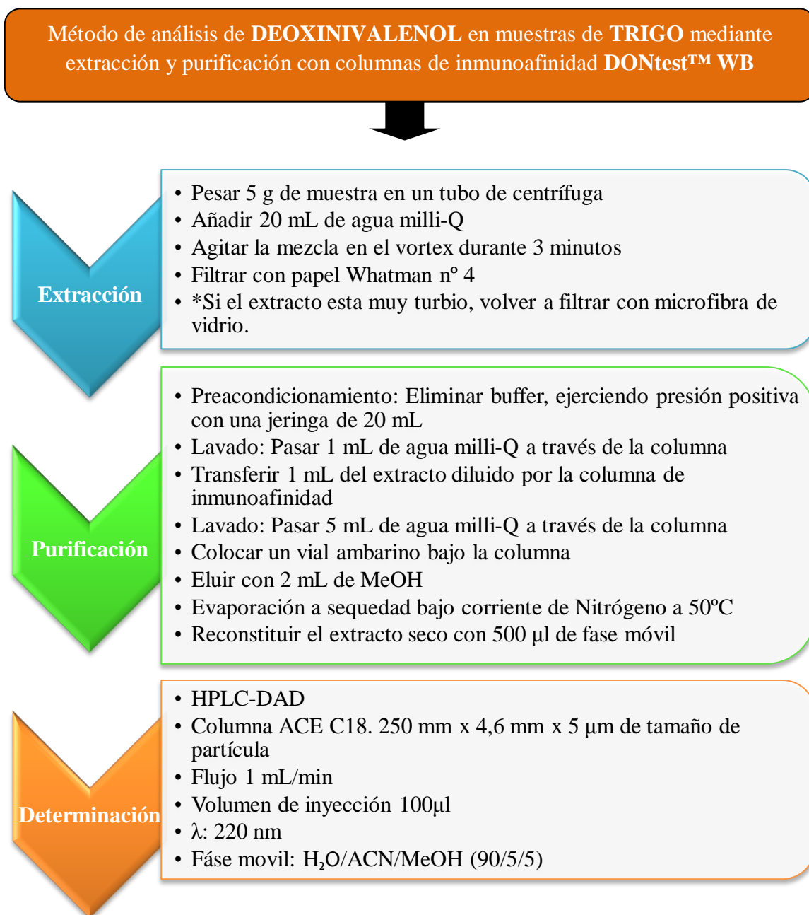
Figura 10. Método de análisis de deoxinivalenol en trigo mediante extracción y purificación con columnas de inmunoafinidad DONtest™ WB.
