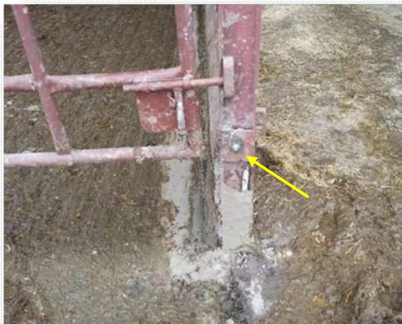
5. El otro extremo del cable se conectó al activador (Feed Intake Activator) que se instaló a una altura de 2 metros en el final del comedero, y otro cable se conectó del activador a la cornadiza para cerrar el circuito, y se conectó a la electricidad (Figura 14).
