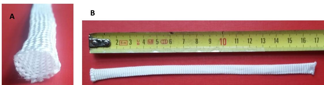
Figura 2: Malla tubular trenzada de polietileno. A: Detalle del espacio en el interior de la malla. B: Detalle longitudinal de la malla.
