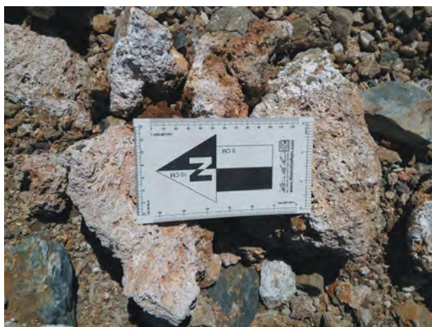
Figura 8: Muestras de calaminas en el perfil DA3 del yacimiento de Anglas.
