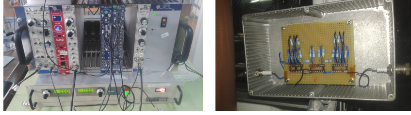
Figura 24: En la imagen de la izquierda puede verse la fuente de alimentación y el amplificador. En la imagen de la derecha se observa la resistencia variable.
