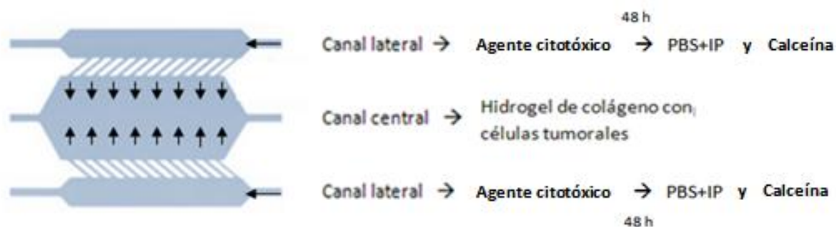
Figura 9: Esquema ensayo citotoxicidad en chips microfluídicos.
