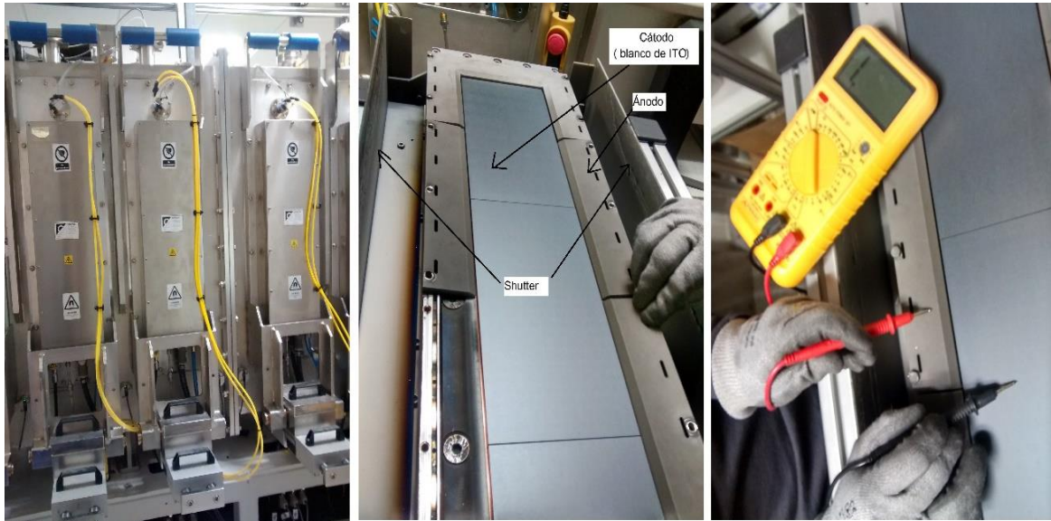
Fig. 2.6 Fotografías de los cátodos De izquierda a derecha: imagen exterior, proceso de instalación del cátodo, y comprobación de que no hay continuidad entre ánodo y cátodo.
