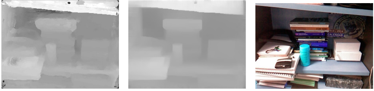
(a) Mapa de profundidades antes de aplicar el regularizador. (b) Mapa de profundidades tras aplicar el efecto del regularizador. (c) Imagen real de los mapas de profundidad de las Figuras 2.4(a) y 2.4(b).
