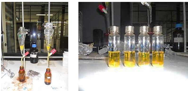
Figura 67. Descarte fase acuosa y adición de sulfato de sodio anhidro fase orgánica.
