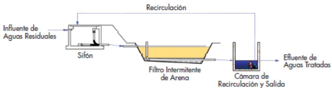
Ilustración 31: Filtro Intermitente de Arena Con Recirculación
