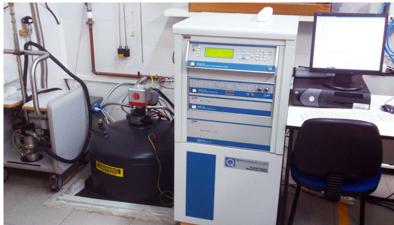
Figura 2.2: Fotografía del PPMS model 5000 de Quantum Design.
