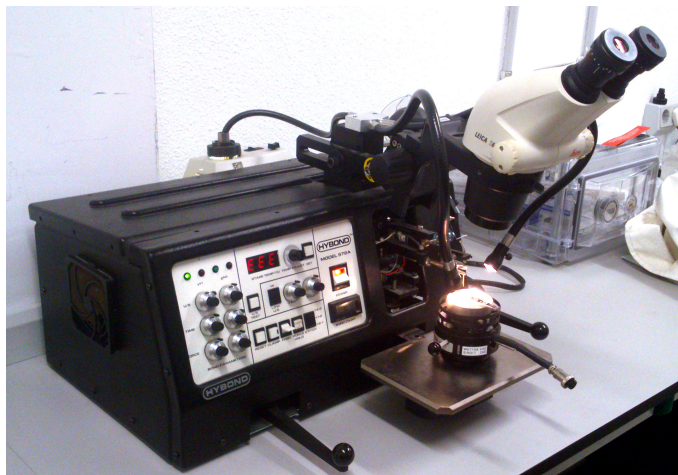
Figura 2.1: Fotografía de la máquina para hacer microcontactos Hybond model 572a.
