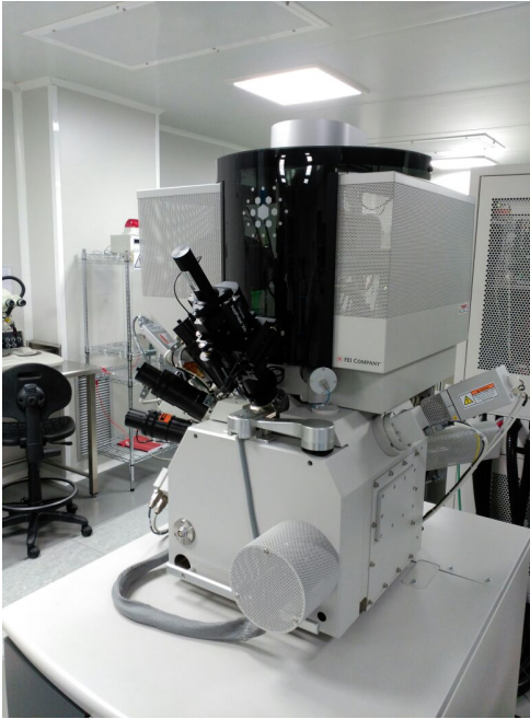
(a) Fotografía del Dual Beam Helios Nanolab 650 en la sala blanca del INA.
