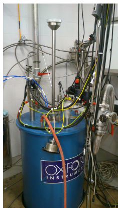
(a) Fotografía del tanque de helio con la caña introducida. En su interior se encuentra el imán vectorial.
