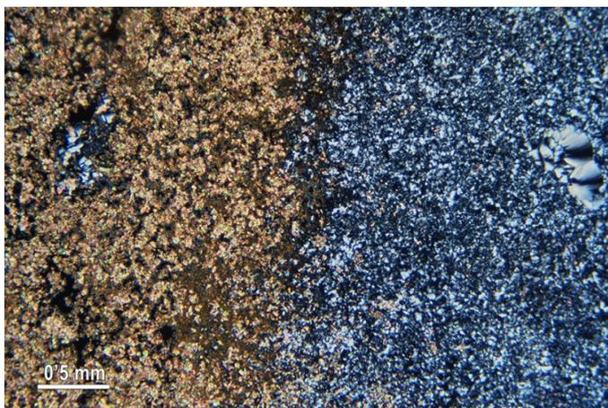
Figura 6: Frente de reemplazamiento de la sílice por carbonato. Imagen de microscopio de luz transmitida en nicoles cruzados.
