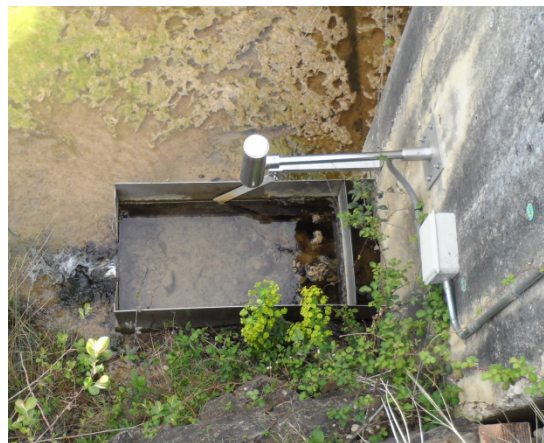
Figura 6.15. Medición automática en aforador
