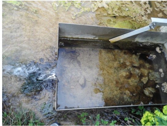
Figura 6.14. Medición manual en aforador
