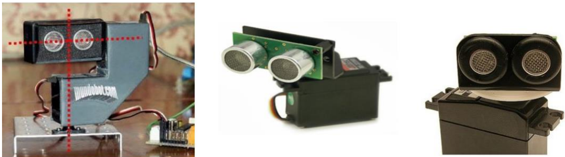
Ilustración 21. Configuración tipo sonar sensores ultrasonidos. Obtenido de: http://www.alcabot.com/alcabot/seminario2006/Trabajos/DiegoPerezDeDiego.pdf
