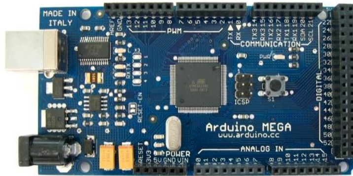
Ilustración 62. Arduino Mega. Obtenido de la página oficial de Arduino.
