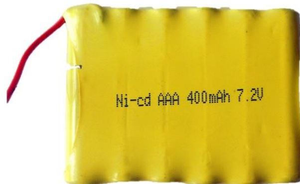
Ilustración 30. Batería Ni-Cd de 6 elementos (7.2V) y 400mAh. Obtenida de: http://roboticasunyer.blogspot.com.es/
