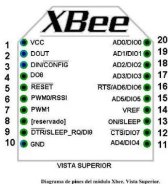
Ilustración 52. Conexión pines Xbee. Esquema y módulo. Obtenida de: http://unicarlos.com/_ARDUINO/Arduino%20+%20XBee.pdf.
