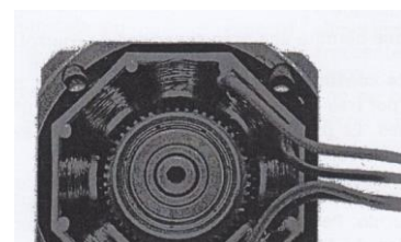
Ilustración 12. Motor paso a paso. Obtenida de: Apuntes automática.
