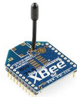
Ilustración 39. Módulo ZigBee S2. Obtenida de: http://www.blogelectronica.com/zigbee-maxstream-modulos-practica-2/
