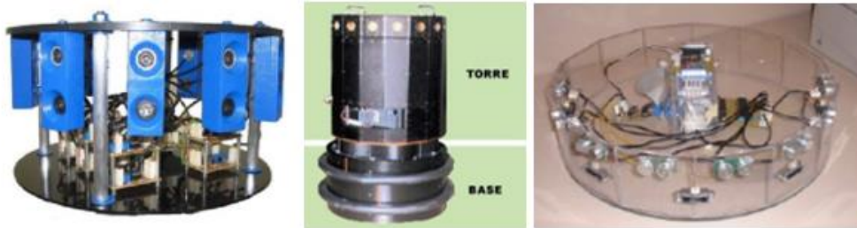
Ilustración 20. Configuración anillo sensores ultrasonidos. Obtenido de: http://www.alcabot.com/alcabot/seminario2006/Trabajos/DiegoPerezDeDiego.pdf
