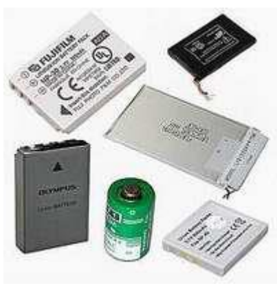
Ilustración 29. Bat. Li-Ion. Obtenida de: http://robots-argentina.com.ar/Energia_baterias.htm
