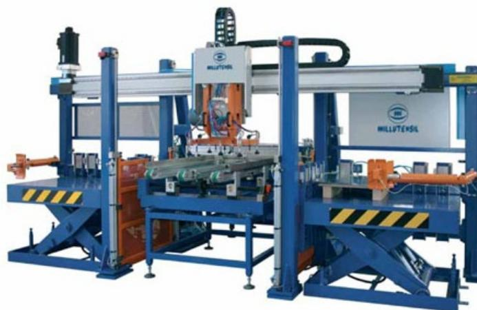
**Ilustración 1: Des apiladora de discos**
