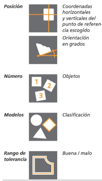
**Ilustración 13: Capacidades del sensor óptico**
