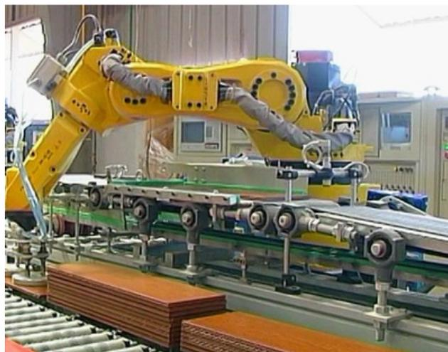
**Ilustración 2: Robot paletizador**
