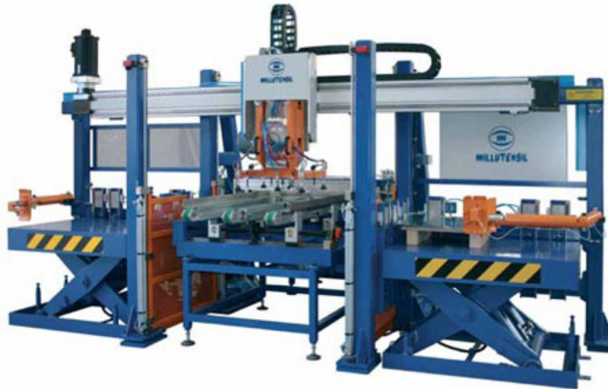
**Ilustración 53: Desapiladora de chapas planas**
