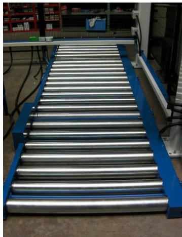
**Ilustración 4: Transfer de rodillos**
