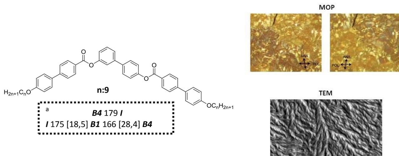
**Figura 1.2** Imágenes de MOP y TEM de una mesofase B4 de la molécula con  $n:9$  de la serie homóloga cuya estructura general se muestra en el lado izquierdo de la imagen<sup>2, a</sup>. Transiciones de fase del compuesto con  $n:9$  T(°C) [ $\Delta H$  (KJ/mol)].
