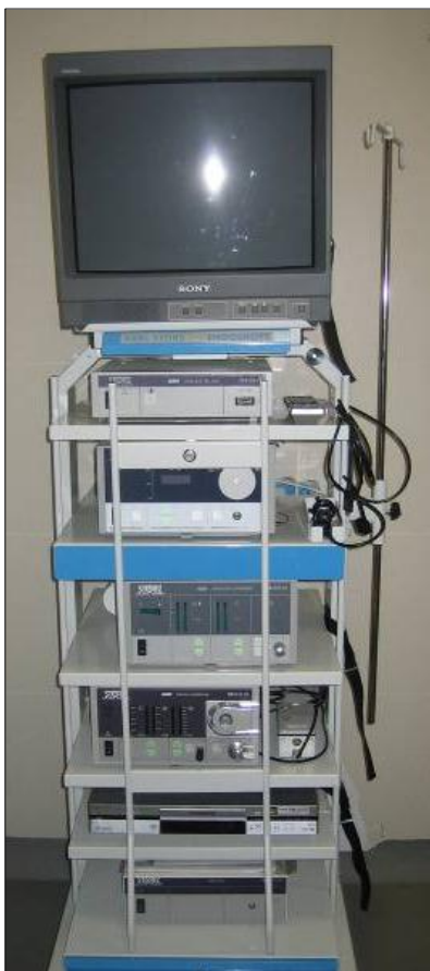
Figura 3.3: Torre de cirugía endoscópica utilizada en el HV-UZ. De arriba abajo: monitor, unidad de control de cámara endoscópica, fuente de luz de xenón, insuflador laparoscópico, bomba de artroscopia, equipo de grabación de video, bomba de aspiración.
