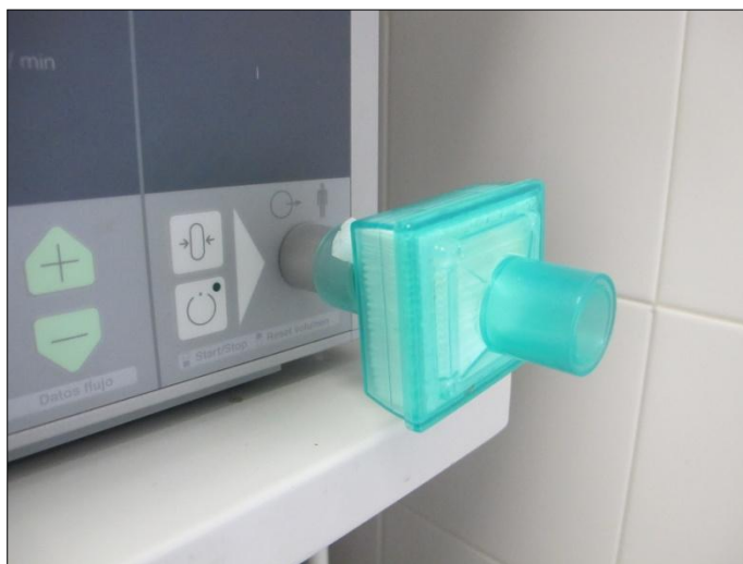
Figura 3.4.: Filtro de gas desechable con conexión ISO conectado a un equipo de insuflación con flujo de gas de hasta 30l/min.
