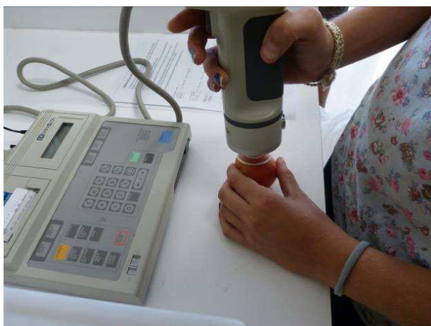
Figura 19. Determinación de los parámetros de color (L, a y b) mediante un colorímetro Minolta modelo CR-200.
