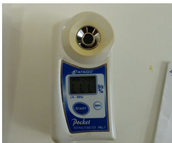
Figura 21. Refractómetro digital utilizado para medir el contenido en sólidos solubles.
