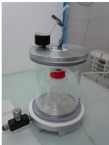
Figura 8. Aplicación de vacío en la pila de combustible tras la infiltración de la disolución con sales metálicas.
