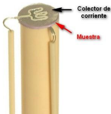
Figura 15. Colocación de la muestra para su ensayo en el dispositivo Probatat.
