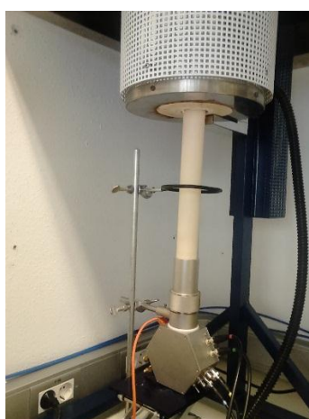
Figura 16. Horno vertical en el cual se han desarrollado los ensayos de las muestras.
