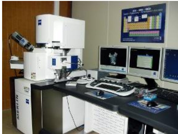
Figura 22. Microscopio electrónico de barrido de emisión de campo (FESEM) Carl Zeiss MERLIN. Servicio de microscopía de la Universidad de Zaragoza.
