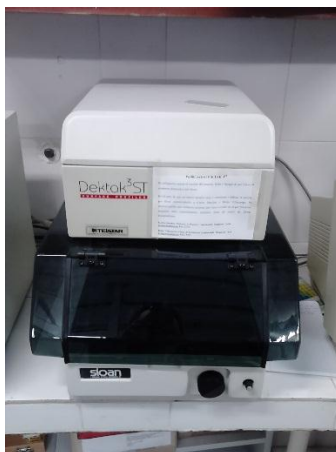
Figura 26. Perfilómetro Dektak 3ST usado para la realización de las medidas de espesores de electrodos.
