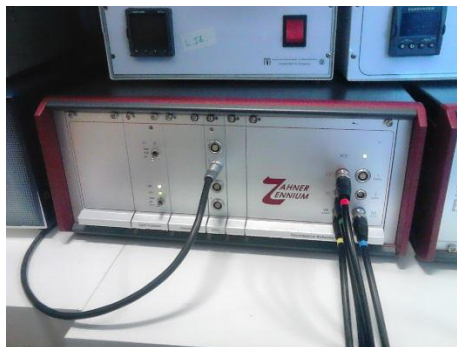
Figura 57. Equipo Zahner Zennium empleado para la caracterización electroquímica de las muestras.
