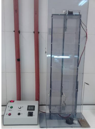
Figura 30. Servo electromecánico empleado para la aplicación de las pastas cerámicas sobre las pilas de combustible.
