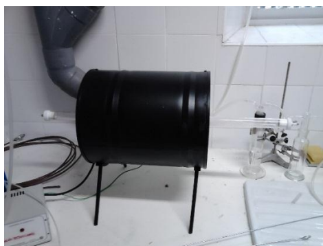
Figura 9. Horno tubular empleado para la calcinación de los nitratos infiltrados en las muestras.
