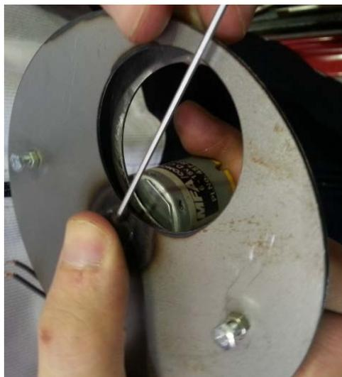
**Figura 10- Ajuste del tornillo de la pieza de unión**
