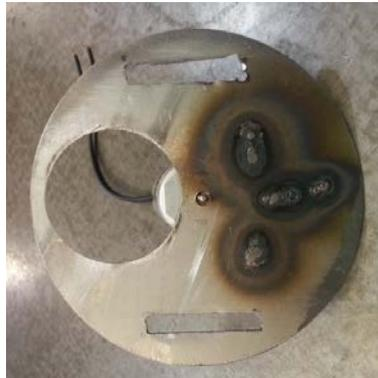
**Figura 17- Ranuras para el microrruptor**
