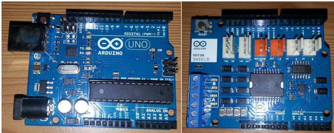
**Figura 15- Arduino UNO y Arduino Motor Shield**
