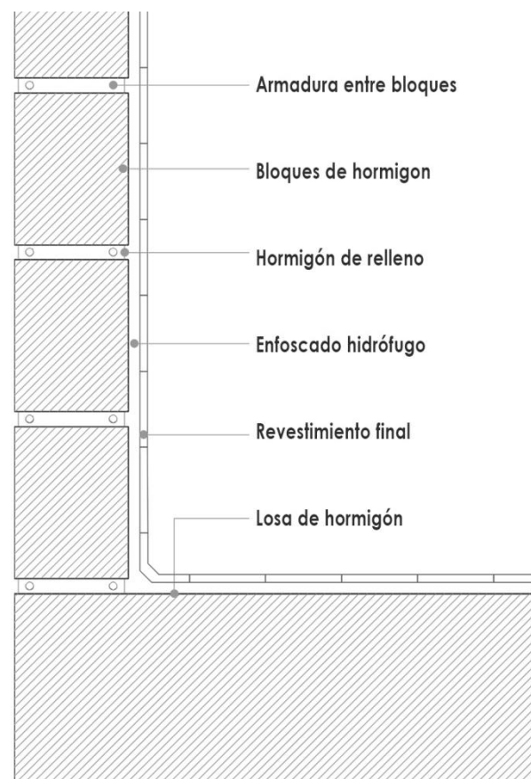
22. Sección de pared de bloques de hormigón
