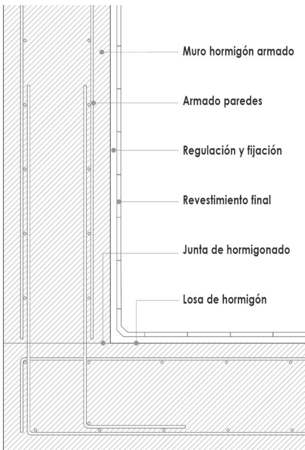
23. Sección de pared de hormigón armado
