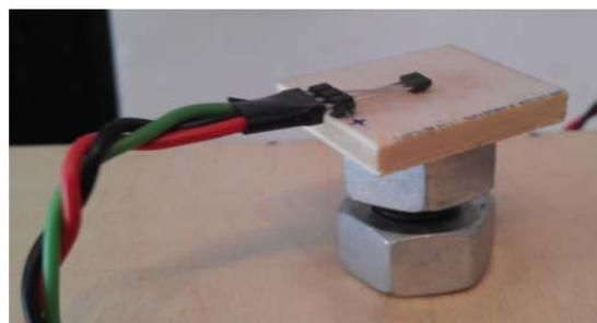
Fig. 44 Detalle del sensor hall superior.
