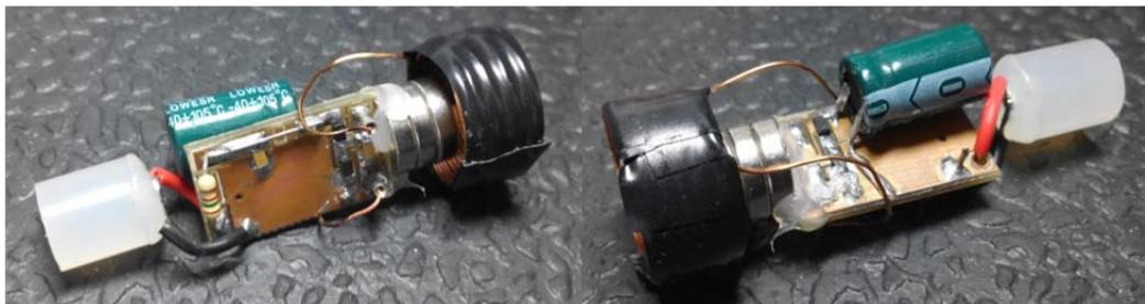
Fig. 47 Detalle del objeto suspendido, donde se ven la bobina receptora, el circuito receptor y rectificador y el LED.
