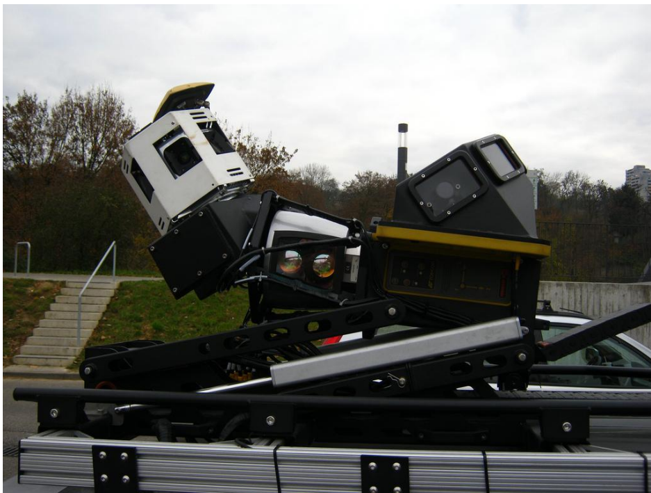
Figura 2 Equipo colocado encima de un coche y que incluye un sensor LIDAR, GPS y cámara panorámica
