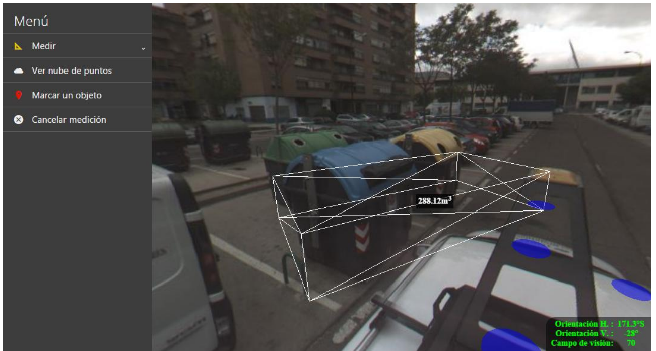
Figura 28 Función de medir volumen, resultado
