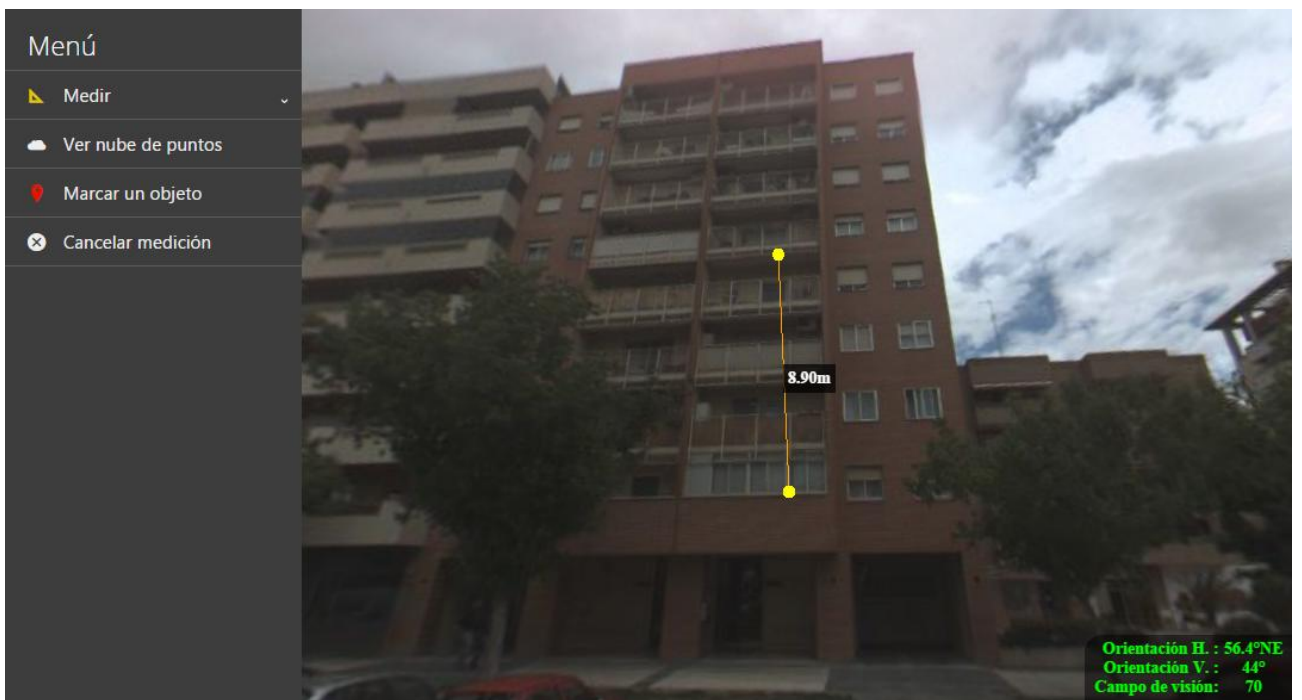
Figura 20 Función de medir distancia, resultado
