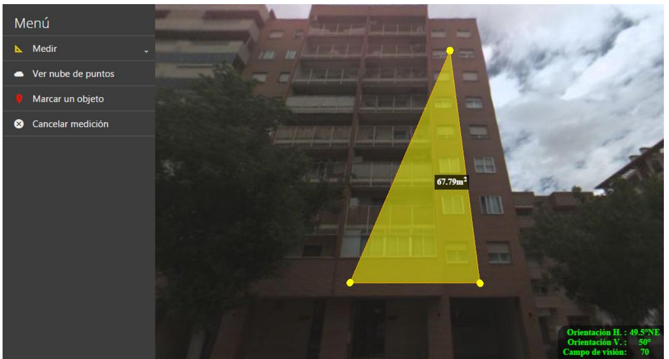
Figura 25 Función de medir área, resultado
