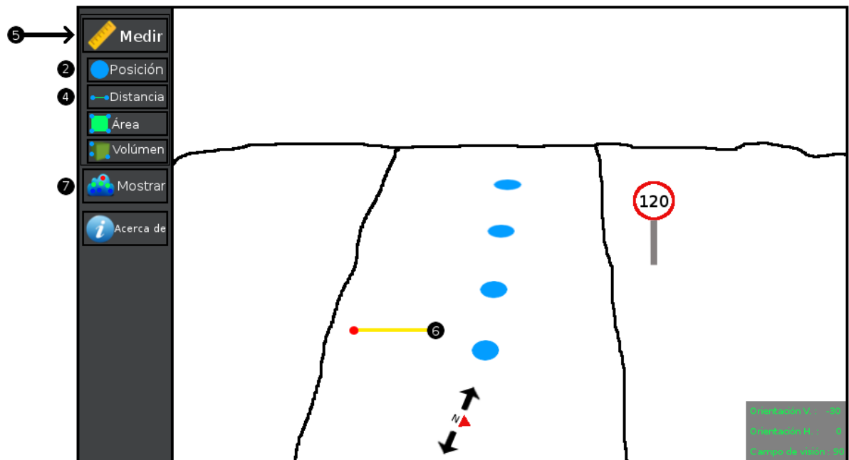
Figura 15 Prototipo GUI, seleccionado primer punto de la medición de distancia
