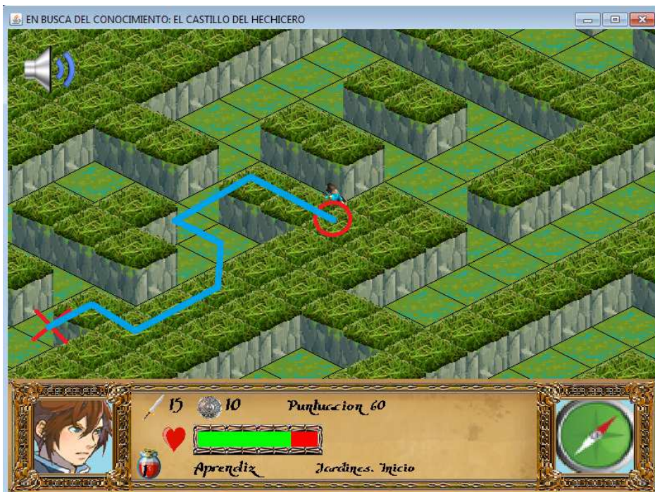
Figura 10. Recorrido del jugador a una posición indicada con el ratón, a través del cálculo de camino óptimo con el algoritmo A*.
