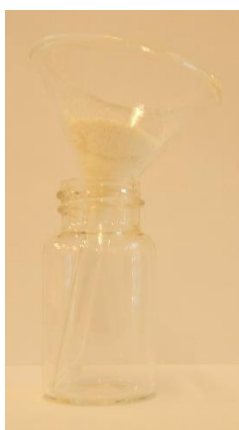
Figura III-7. Embudo con sulfato de magnesio anhidro.
