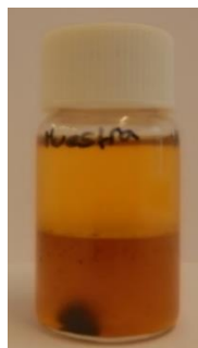
Figura III-3. Separación fases de heptano y ácido en el vial.
