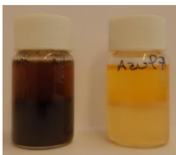
Figura III-4. Separación de las fracciones acuosa y de diclorometano (izquierda) y de las fracciones de heptano y acuosa (derecha) en sus correspondientes viales.
