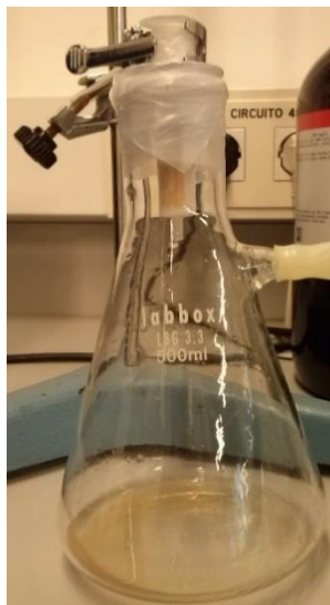
Figura III-16. Montaje experimental para la extracción en fase sólida.
