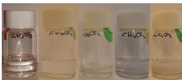
Figura IV-11. Viales fracción de CH 2 Cl 2 de extracción de la fracción básica de fases acuosas, del experimento 1 (izquierda) al 5 (derecha).
