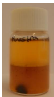
Figura 1. Separación de las fracciones de heptano (arriba) y ácido (abajo) en el vial muestra.
