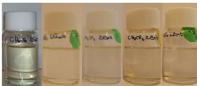
Figura IV-8. Viales fracción de \text{CH}_2\text{Cl}_2 de extracción doble de fases acuosas, del experimento 1 (izquierda) al 5 (derecha).
