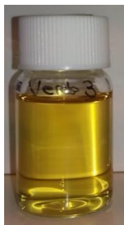
Figura III-20. Vial de acetoneitrilo obtenido al aplicar el método de extracción en fase sólida.
