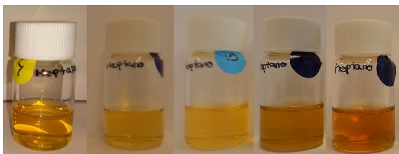
Figura IV-1. Viales fracción de heptano de fases orgánicas pesadas, del experimento 1 (izquierda) al 5 (derecha), siendo esta una única fase orgánica.
