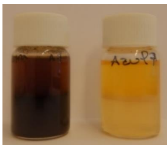
Figura 3. Separación de las fracciones acuosa ácida y de diclorometano (izquierda) y separación de las fracciones de heptano y acuosa básica (derecha) en sus correspondientes viales.
