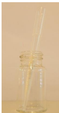
Figura III-5. Punta de micropipeta con sulfato de magnesio anhidro.
