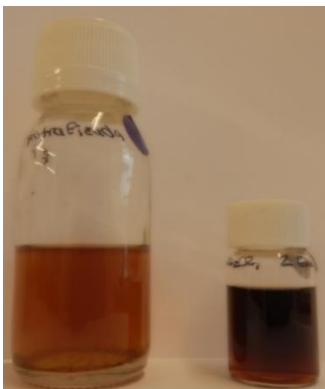
Figura III-10. Frasco fracción ácida neutralizada (izquierda) y vial \text{CH}_2\text{Cl}_2 extracción doble (derecha).
