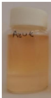
Figura 4. Vial de 26 ml con las fracciones acuosa, arriba, y de diclorometano, abajo.
