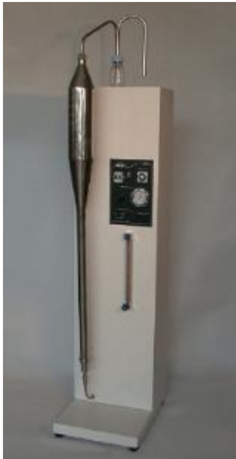
Figura A3: Aparato para la medida de atrición conforme ASTM D5757-00
