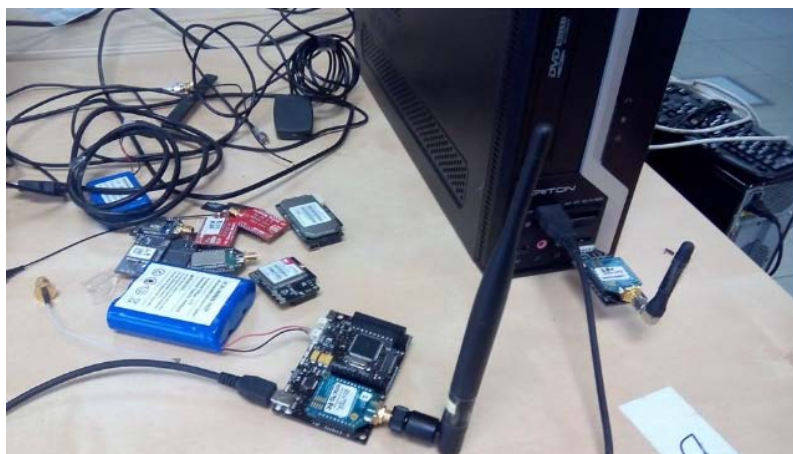
Fig. 3.6. Setup de medida con un módulo ZigBee
