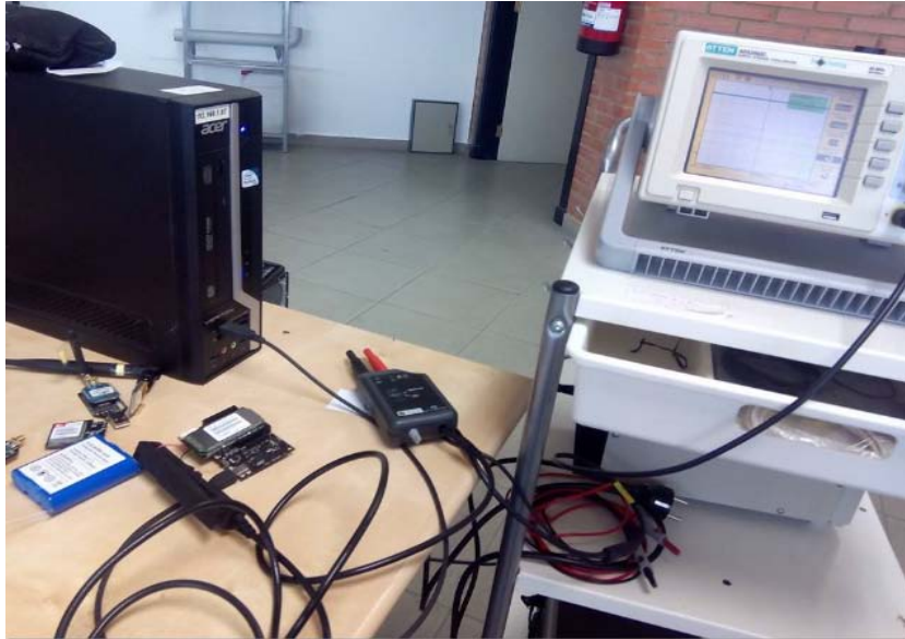
Fig. 3.4. Setup de medida midiendo con el módulo 3G
