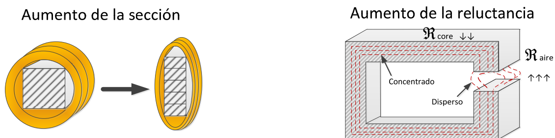
Figura 56 Métodos para evitar la saturación del material
