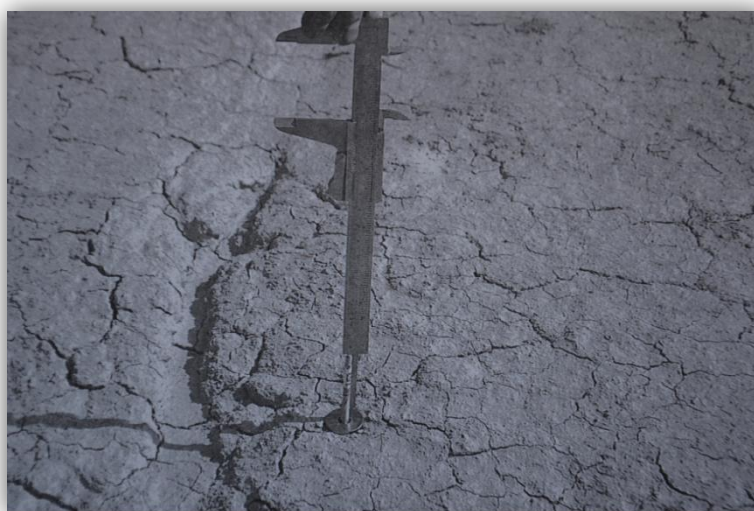
Fotografía 40. Aguja de erosión. Fuente: Sancho et al. (1991)
