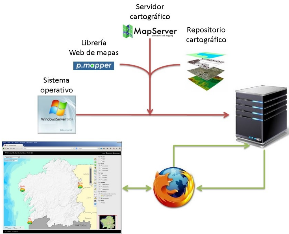
Figura 37: Esquema de la arquitectura del sistema web de mapas.
