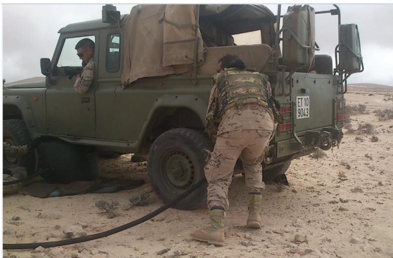
Ilustración 26 - Balón inflable por gases de escape
