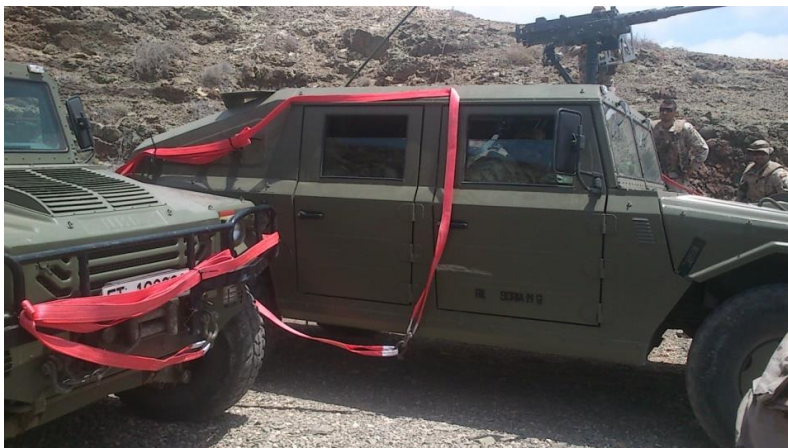
Ilustración 28.1 - Procedimiento de recuperación de vehículos
