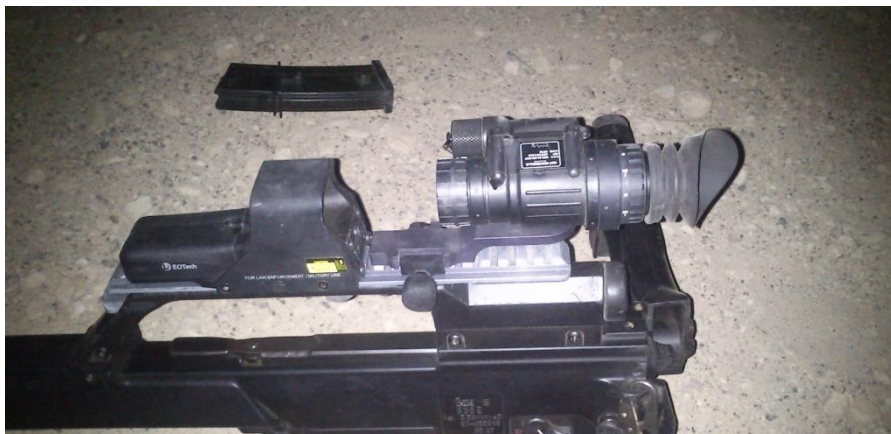
Ilustración 30 - Fusil HK G36 con VISOR HOLOGRÁFICO EOTECH y MONOCULAR VN AN-PVS14
