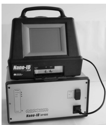
Figura 9 Imagen del Nanoparticle Spectrometer utilizado en la presente tesis.
