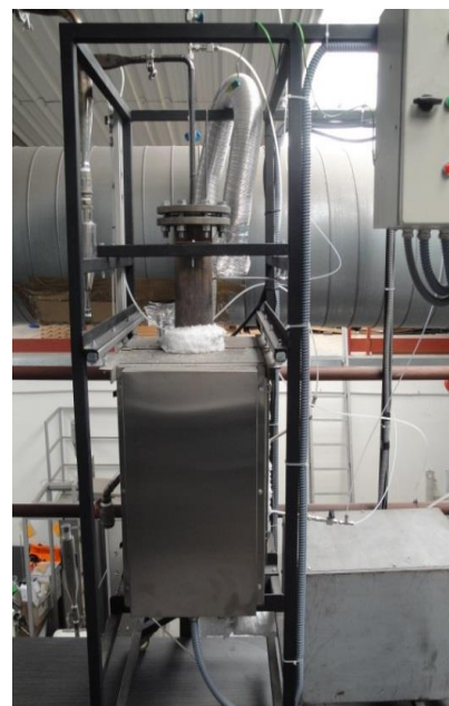
Figura 2.8. Fotografía de la instalación de lecho fluidizado discontinuo.
